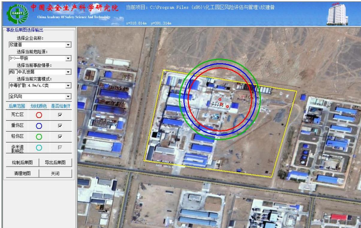
图 3.4.5-6 一甲胺储罐阀门中孔泄漏中毒事故后果图
