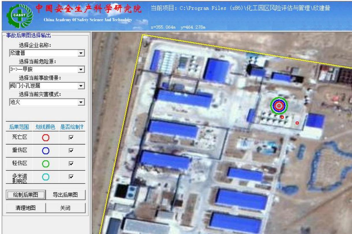
图 3.4.5-3 一甲胺储罐阀门小孔泄漏池火事故后果图
