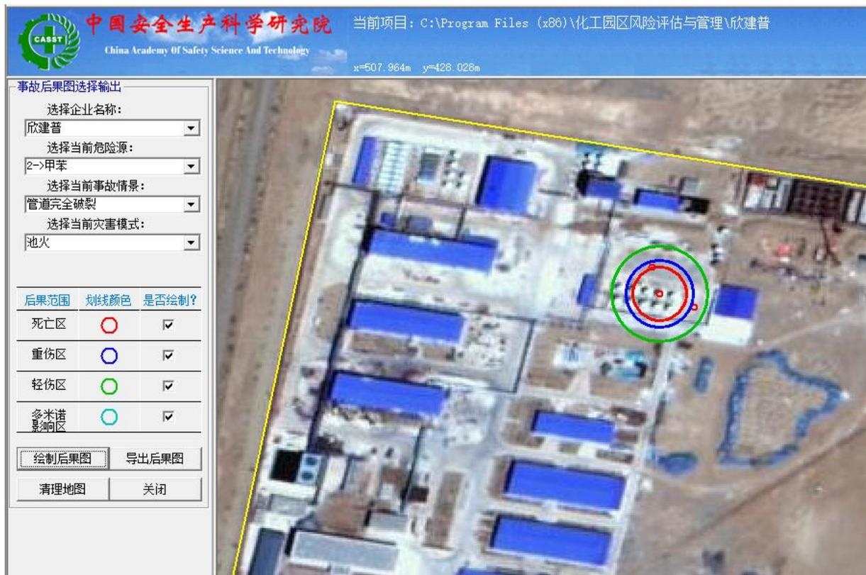
图 3.4.5-15 甲苯储罐管道完全破裂池火事故后果图
