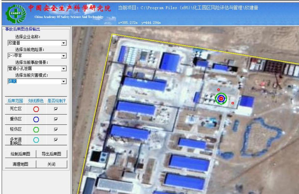
图 3.4.5-12 甲苯储罐管道小孔泄漏池火事故后果图
