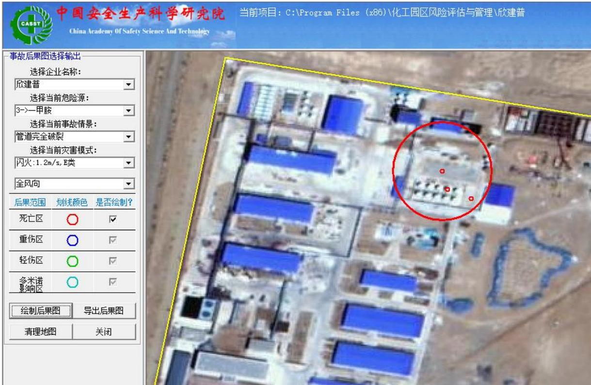
图 3.4.5-8 一甲胺储罐管道完全破裂闪火事故后果图
