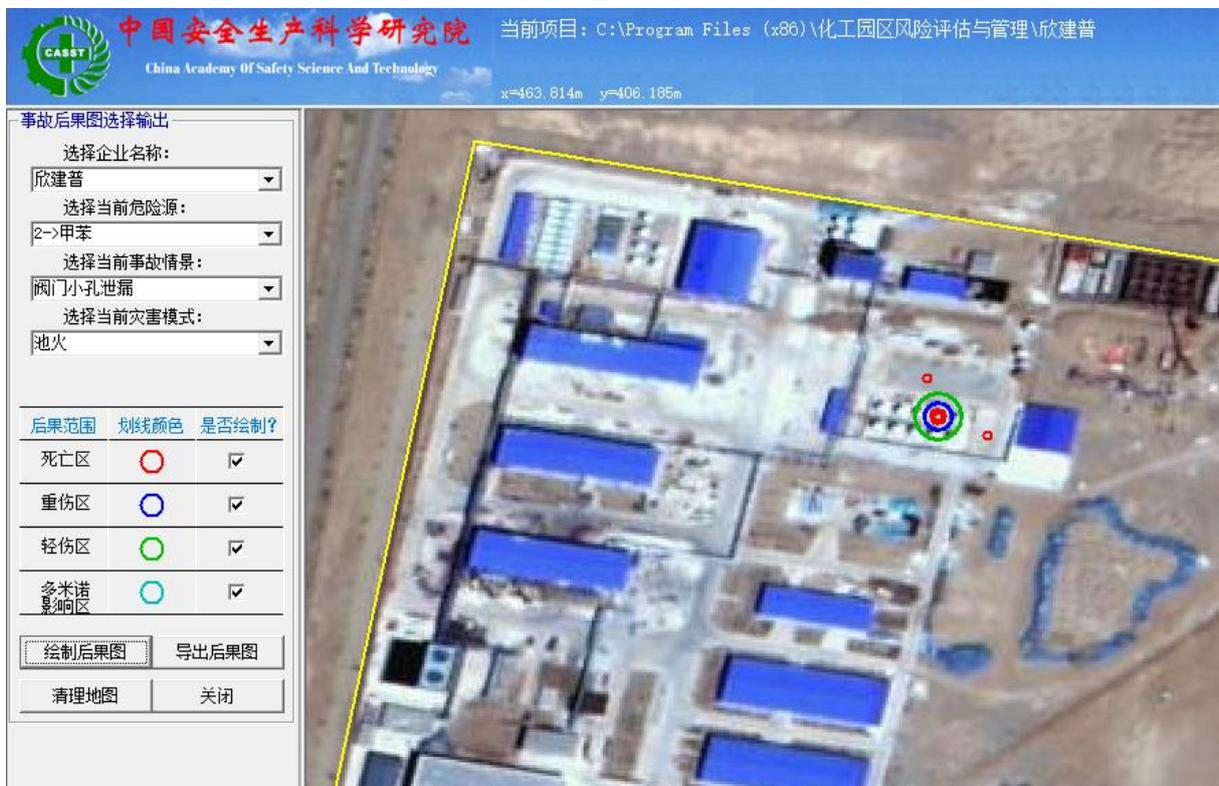
图 3.4.5-13 甲苯储罐阀门小孔泄漏池火事故后果图
