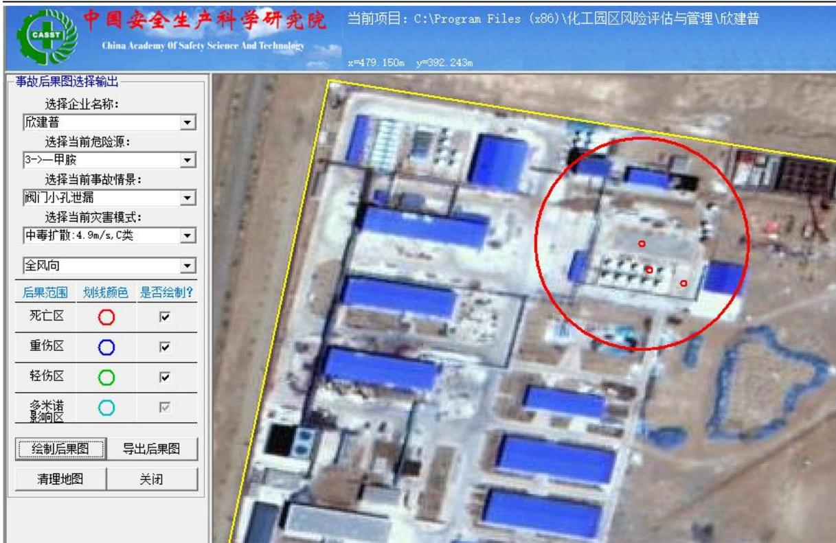
图 3.4.5-4 一甲胺储罐阀门小孔泄漏中毒事故后果图
