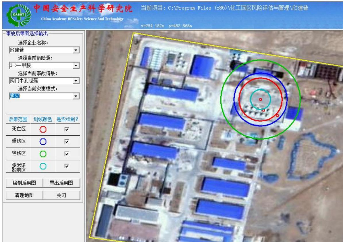
图 3.4.5-5 一甲胺储罐阀门中孔泄漏池火灾事故后果图
