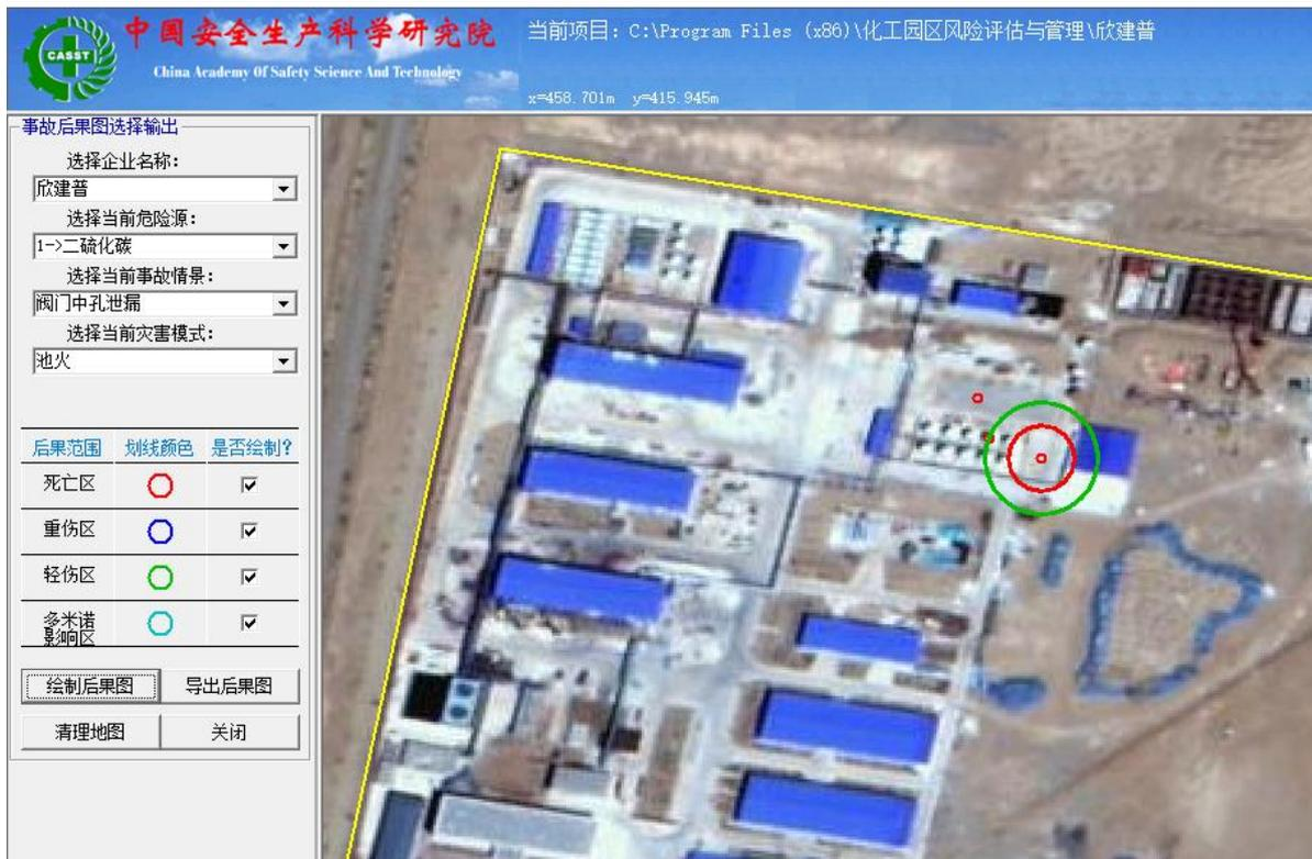
图 3.4.5-10 二硫化碳储罐阀门中孔泄漏池火事故后果图
