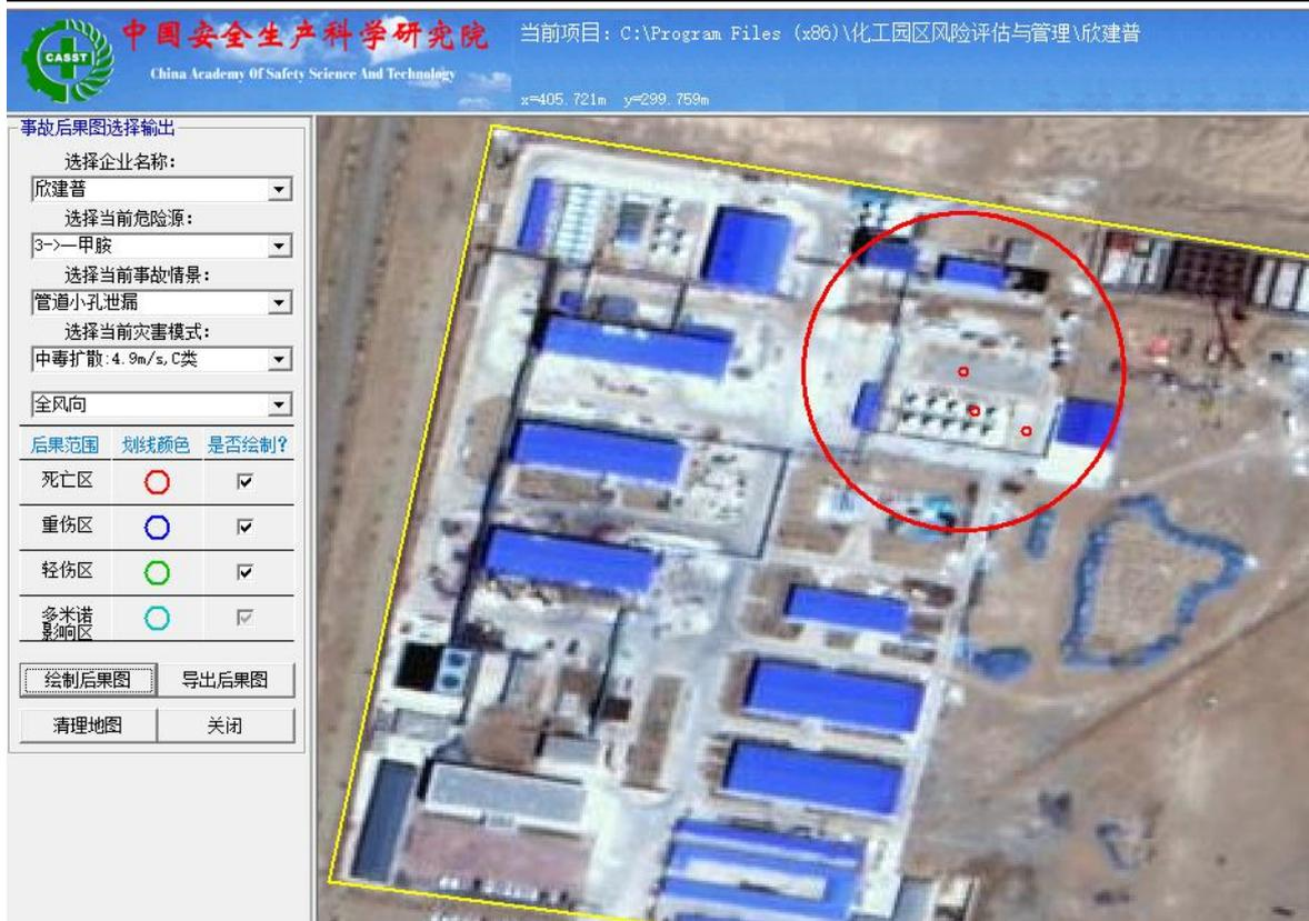
图 3.4.5-2 一甲胺储罐管道小孔泄漏中毒事故后果图
