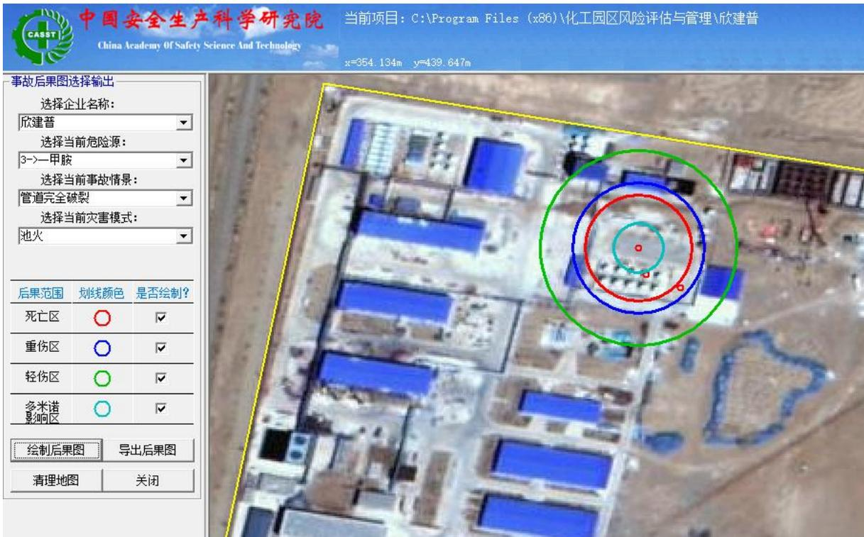
图 3.4.5-7 一甲胺储罐管道完全破裂池火事故后果图
