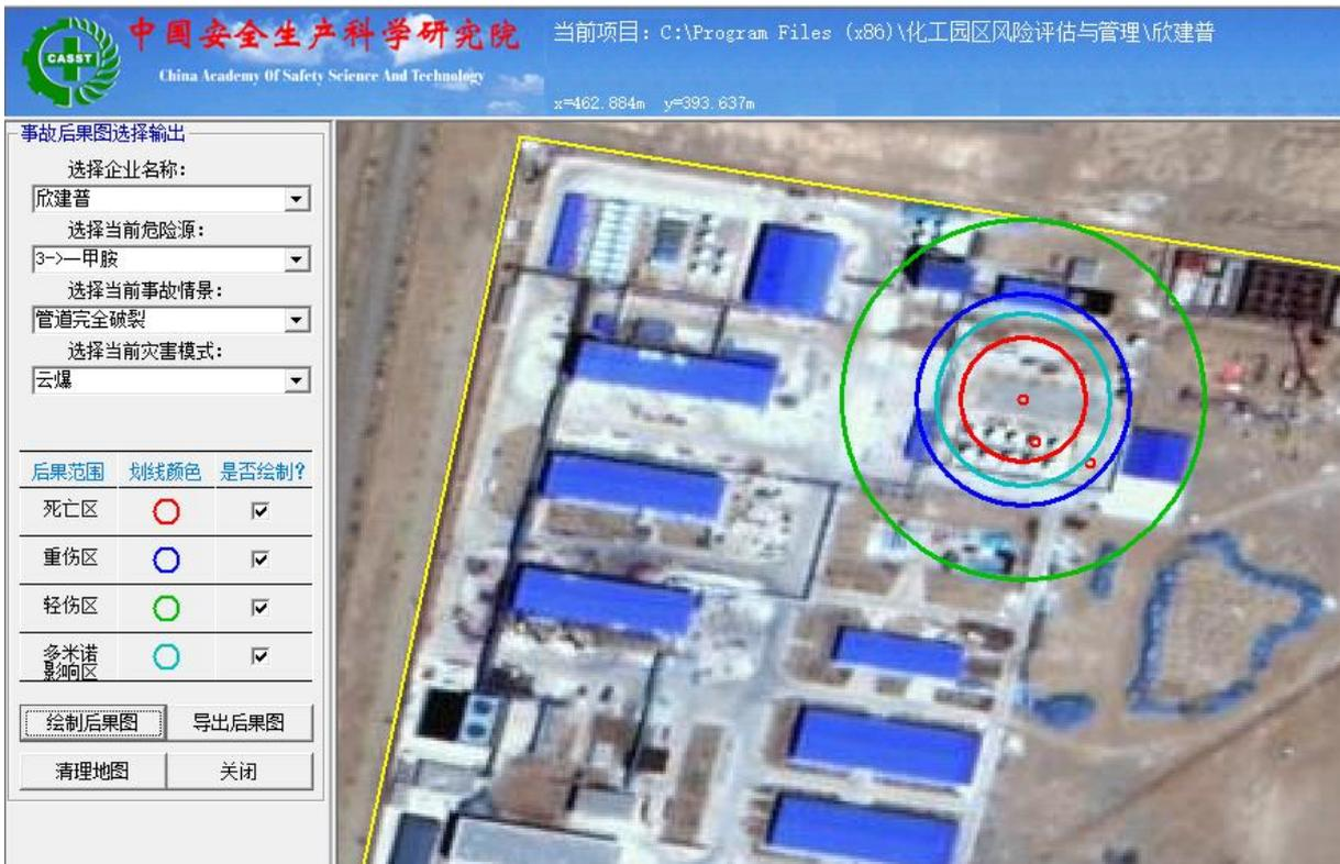
图 3.4.5-9 一甲胺储罐管道完全破裂云爆事故后果图
