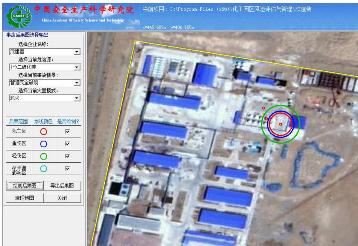
图 3.4.5-11 二硫化碳储罐管道完全破裂池火事故后果图
