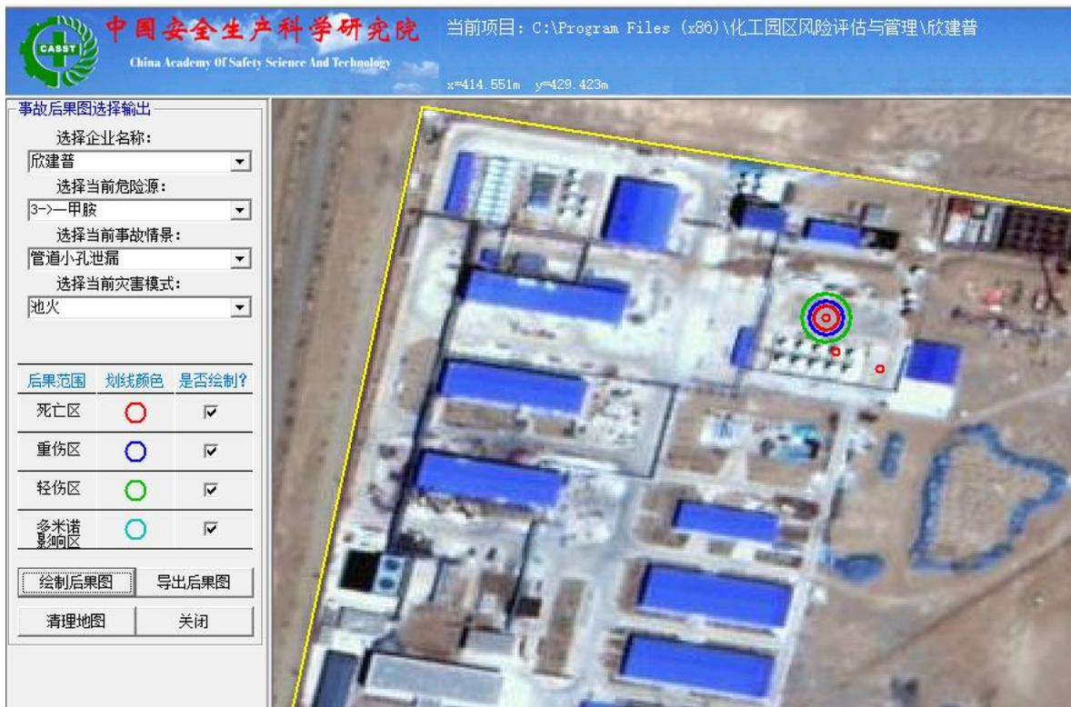
图 3.4.5-1 一甲胺储罐管道小孔泄漏池火事故后果图
