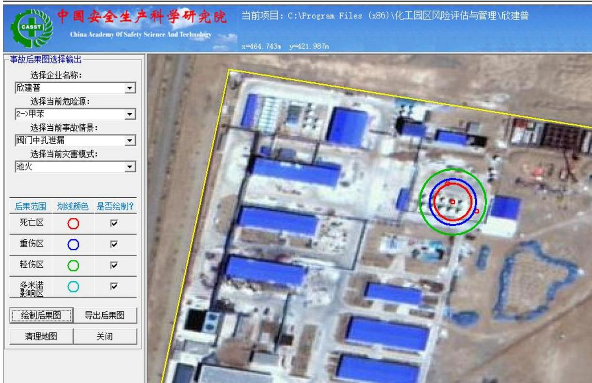
图 3.4.5-14 甲苯储罐阀门中孔泄漏池火事故后果图
